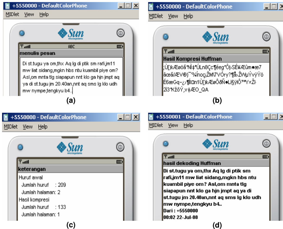
Gambar 8 Proses kompresi SMS dengan menggunakan algoritma Huffman kanonik. (a) Keadaan awal teks SMS. (b) Teks setelah dikompresi. (c) Keterangan hasil kompresi. (d) Teks SMS setelah diterima dan dilakukan proses dekoding.
